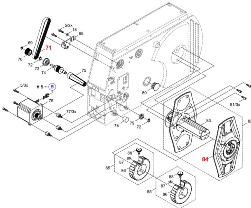
Figure 7 - TE3112/TE3124-PRINTER
